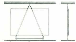
Le pareti mobili divisorie degli uffici al mezzanino.
